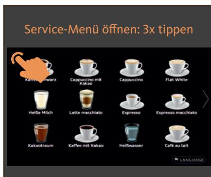
20 Service-Menü auf dem Touchscreen öffnen. Menü **REINIGUNG** öffnen. Menü **START REINIGUNG KOMPLETT** auswählen und bestätigen. Die dialoggeführte Reinigung starten und den Anweisungen folgen.
