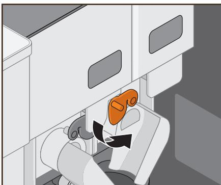
4 Verschlusskappen an den Produktrutschen der Produktbehälter schließen und die Produktbehälter aus dem Gerät entnehmen.
