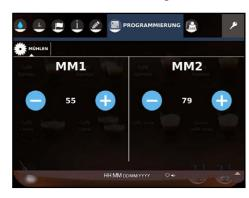
• Drücken Sie für das entsprechende Mahlwerk (,MM1'/,MM2') die Taste 🛨 oder 😑 , um die Position des entsprechenden Mahlwerks einzustellen.
