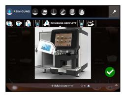
Füllen Sie den Spezialreiniger für Milchund Sahnegeräte in den linken Bereich des Reinigungsbehälters.
