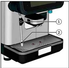
Verbrennungsgefahr am Ausgaberohr!
