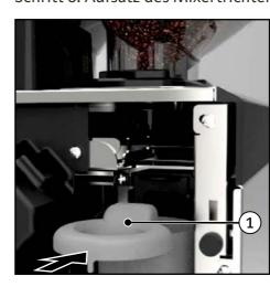
• Schieben Sie den Aufsatz (1) des Mixertrichters an die ursprüngliche Position auf dem Mixertrichter.
