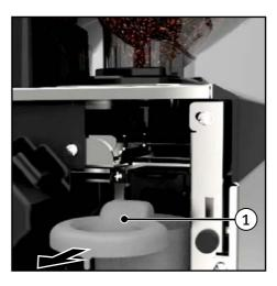
• Ziehen Sie den Aufsatz (1) des Mixertrichters nach vorne von dem Mixertrichter ab.
