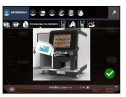
Füllen Sie den Spezialreiniger für Milchund Sahnegeräte in den linken Bereich des Reinigungsbehälters. (Informationen zur Dosiermenge finden Sie auf dem Kanister des Spezialreinigers für Milch- und Sahnegeräte.)
