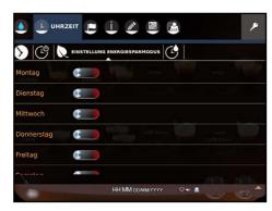
In der Abbildung wird die Grundeinstellung der Standby-Funktion angezeigt (Der Stand-by-Betrieb ist für alle Wochentage deaktiviert).
