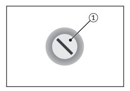
Stecken Sie den Schlüssel in den Schlüsselschalter und drehen Sie ihn in die Position (1).
