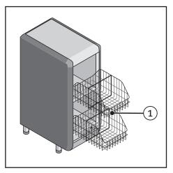
• Stellen Sie die gereinigten Edelstahlkörbe (1) auf die Wärmeplatten.
