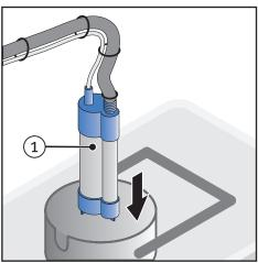
Setzen Sie die Tauchpumpe (1) in den Wasserkanister
