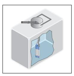
Stellen Sie sicher, dass sich die eingesetzte Tauchpumpe in senkrechter Position befindet und den Boden des Wasserkanisters berührt.
