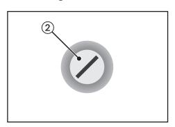
• Stecken Sie den Schlüssel in den Schlüsselschalter und drehen Sie ihn in die Position (2).
