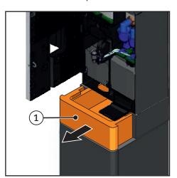
• Ziehen Sie die Schublade (1) aus der Unterstelleinheit.
