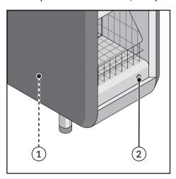
• Schalten Sie die zwei Wärmeplatten des Tassenwärmers an dem Netzschalter (1) ein (Schalterstellung "I").
