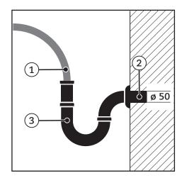
Der Abwasseranschluss (2) muss einen Durchmesser von min. 50 mm aufweisen und mit einem Siphon (3) ausgestattet sein
