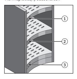
• Schalten Sie die Wärmeplatten des Tassenwärmers an den entsprechenden Netzschaltern (1), (2), (3) aus (Schalterstellung, O').
