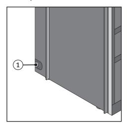
• Schalten Sie die vier Wärmeplatten des Tassenwärmers an dem Netzschalter (1) ein (Schalterstellung ,I').
