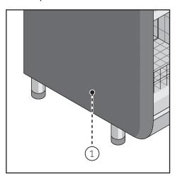
• Schalten Sie die zwei Wärmeplatten des Tassenwärmers an dem Netzschalter (1) aus (Schalterstellung ,O').
