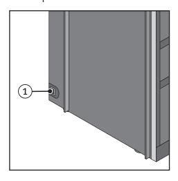
• Schalten Sie die vier Wärmeplatten des Tassenwärmers an dem Netzschalter (1) aus (Schalterstellung ,O').
