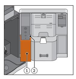
Der Münzbehälter ist mit einem Schloss gegen unbefugten Zugriff und gegen Diebstahl gesichert.
