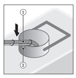
Drücken Sie die Trinkwasserleitung (1) zusammen mit dem Kabel der Spannungsversorgung in Pfeilrichtung und in die Aussparung (2) am Einfüllstutzen des Wasserkanisters.
