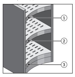
• Schalten Sie die Wärmeplatten des Tassenwärmers an den entsprechenden Netzschaltern (1), (2), (3) ein (Schalterstellung, J').
