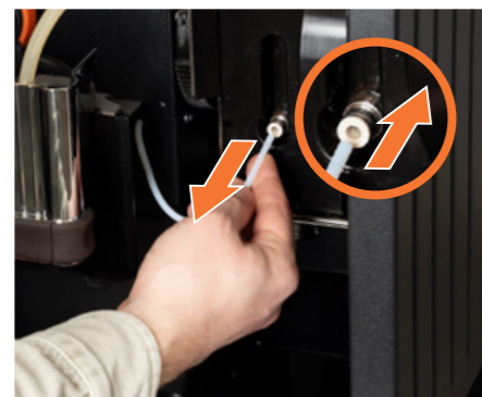
7 Ziehen Sie den Brüherzulauf heraus, indem Sie zeitgleich die weiße Schlauchverriegelung hereindrücken.
