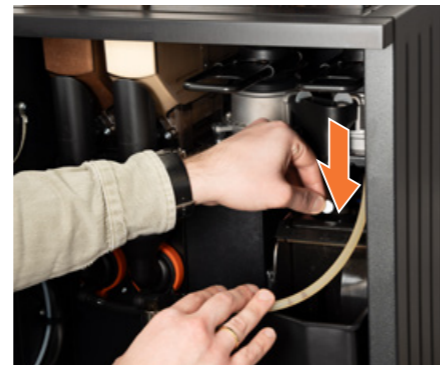
3 Gerätetür Öffnen und Reinigungstablette in den Brüher geben.
