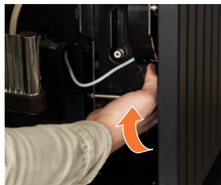
8 Entriegelungshebel unter dem Brüher nach vorne klappen.
