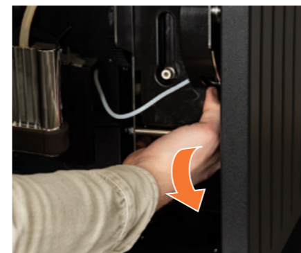
16 Entriegelungshebel unter dem Brüher nach hinten klappen, bis dieser einrastet.
