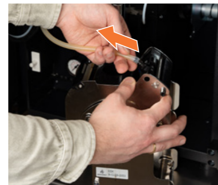
10 Kaffeeauslaufschlauch vom Brüher abziehen und den Brüher zur Reinigung bereitstellen.
