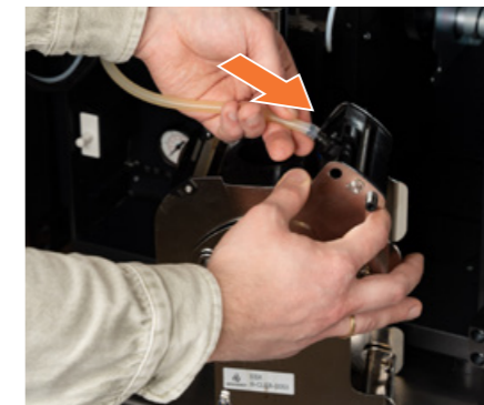
14 Kaffeeauslaufschlauch mit dem Brüher verbinden.
