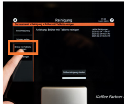
2 Wählen Sie: Reinigung > Brüher mit Tablette reinigen .
