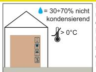
Bei längerer Lagerung bei Temperaturen unter 2°C muss der Hydraulikkreis der Maschine vom Kunden vorher entleert werden. Die Maschine nicht einschalten, sie mindestens 1 Stunde lang an einem Ort mit geeigneter Raumtemperatur überholt wurde.
