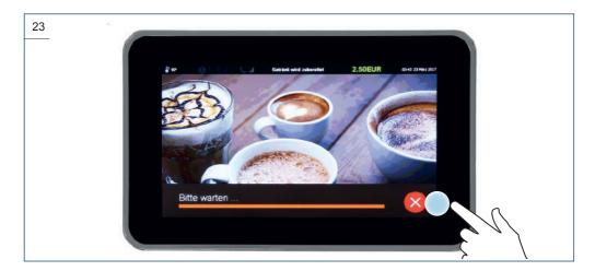
Die manuelle Unterbrechung der Ausgabe erfolgt nicht sofort, sondern erst nachdem das System geprüft hat, dass dies die Sicherheit der Maschine nicht beeinträchtigt.
