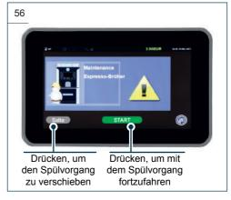
Sofern der Installationstechniker die Spülfunktion mit Timer aktiviert hat, fordert die Maschine bei Ablauf der eingestellten Zeit zur Ausführung des Spülvorgangs auf. Diese kann bei Bedarf einmalig aufgeschoben werden.
